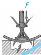
L'implantation sur un vide : elle est dangereuse car elle entraîne une déformation de la planche, voire sa rupture.
