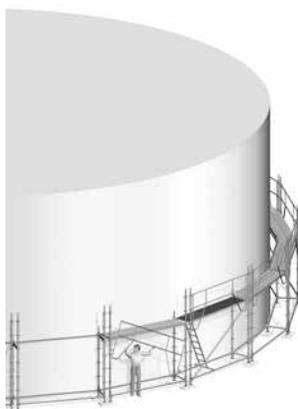
Le support plancher pour échafaudage circulaire (détail 1) permet de constituer des angles de  $15^\circ$  à  $45^\circ$  laissant une totale liberté pour un maillage circulaire.
