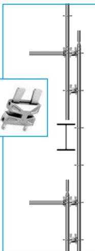
Le nouveau profil décaissé des planchers Layher permet d'assurer des continuités de platelage, en passant au-dessus des disques.
