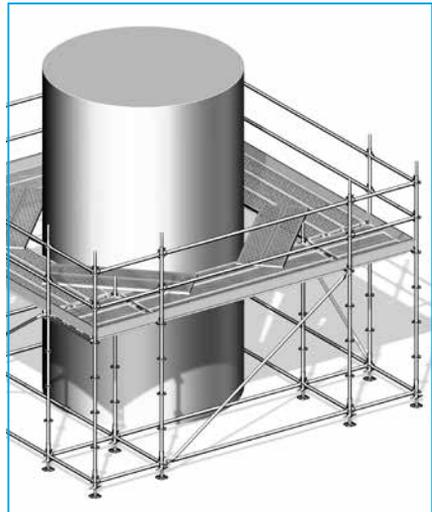
\* En cas d'utilisation de planches en bois, celles-ci devront être classées ST I ou II, de 40 mm d'épaisseur, ferrées en about et calculées en conséquence. Recouper la portée des planches dès qu'elle dépasse 1 m 50.
