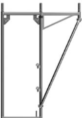
La console de 1,088 doit être renforcée par un bracon 1741.195
